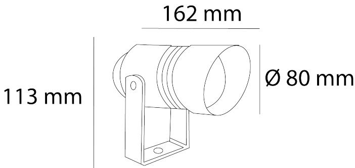
**Instalación:** Fijar la base del luminario a la pared o a estaca, cablear y atomillar el luminario a la base.
