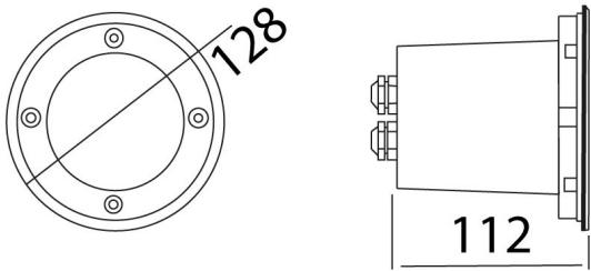
**Instalación:** Crear perforación en piso de 12 cm de profundidad y 10 cm de ancho, introducir la caja de empotrar, cablear e introducir el luminario.
