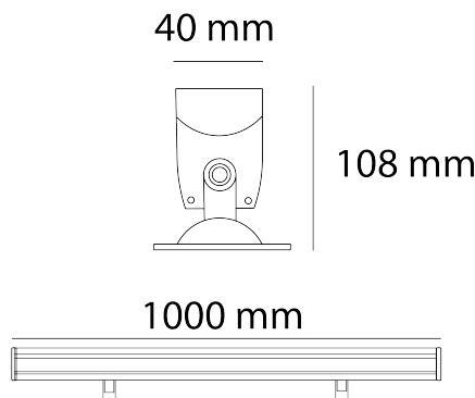
**Instalación:** Fijar las bases del luminario a piso, techo o muro, cablear y fijar el luminario a las bases mediante los tornillos integrados.
