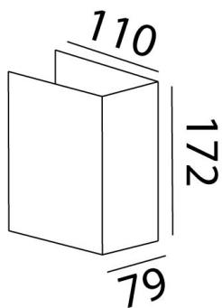
**Instalación:** Fijar la base de luminario a pared, cablear, poner el luminario en la base y fijar con los tornillos integrados.
