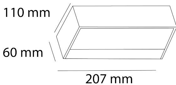
**Instalación:** Fijar la base de luminario a pared, cablear, poner el luminario en la base y fijar con los tornillos integrados.
