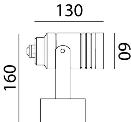
**Instalación:** Fijar la base del luminario a la pared, cablear y atomillar el luminario a la base.
