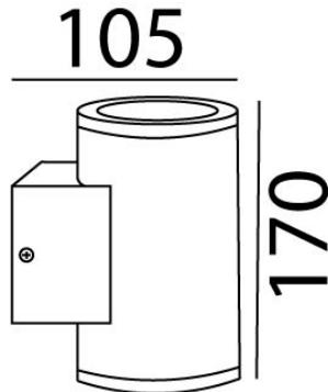
**Instalación:** Fijar la base de luminario a muro, cablear, fijar el luminario a la base mediante los tornillos integrados.
