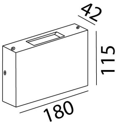
**Instalación:** Fijar la base de luminario a pared, cablear, poner el luminario en la base y fijar con los tornillos integrados.
