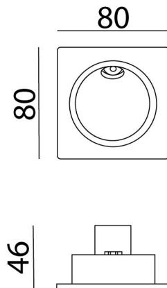
**Instalación:** Empotrar la caja de metal en la pared (incluida), cablear el luminario y ponerlo a presión en la caja.
