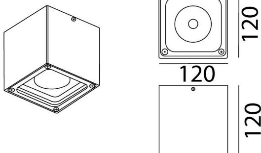
**Instalación:** Fijar la base de luminario a techo, cablear, poner el luminario y fijar con los tornillos integrados.
