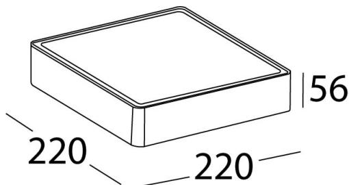
**Instalación:** Cablear el luminario, fijarlo con tornillos a techo y colocar la tapa a presión.
