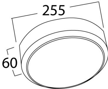
**Instalación:** Cablear el luminario, fijarlo con tornillos a techo y colocar la tapa a presión.
