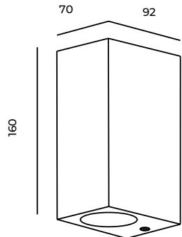
**Instalación:** Cablear el luminario, fijarlo con tornillos a muro y colocar la tapa con los tornillos incluidos.
