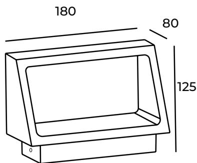
**Instalación:** Fijar la base de luminario a pared, cablear, poner el luminario en la base y fijar con los tornillos integrados.
