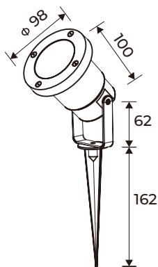
**Instalación:** Fijar la base de luminario a la estaca, cablear, fijar en jardín.
