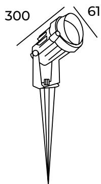
**Instalación:** Fijar el luminario a la estaca, colocar en el jardín y cablear.
