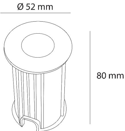
**Instalación:** Realizar un agujero en el suelo en donde entre el housing de la luminaria cablear y poner la luminaria dentro del housing
