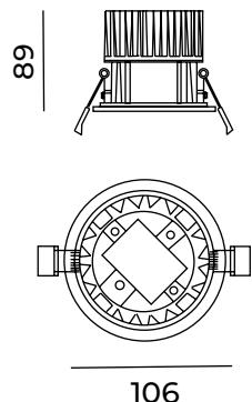
**Instalación:** Perforar el techo 90 mm, cablear el luminario, e introducirlo.
