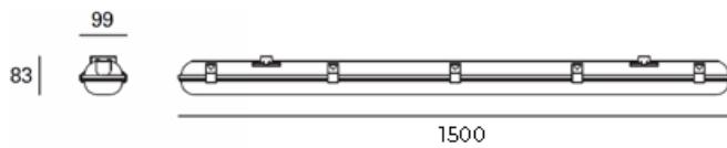
**Instalación:** Para el montaje se fijan los soportes al techo y se coloca a presión el luminario.
