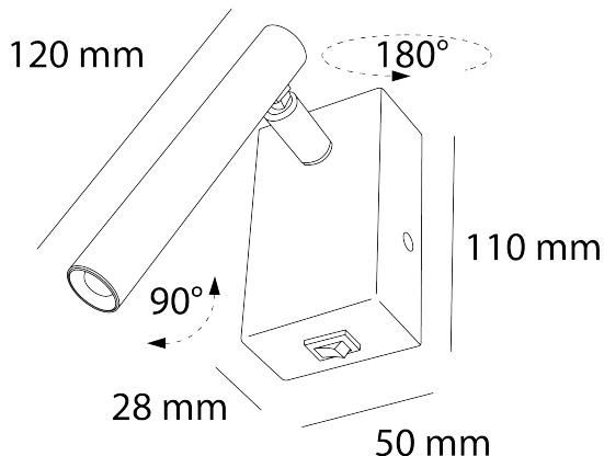
**Instalación:** Montar la placa base al muro con los tornillos incluidos en la caja, montar la luminaria en la placa base y asegurar con los tornillos laterales
