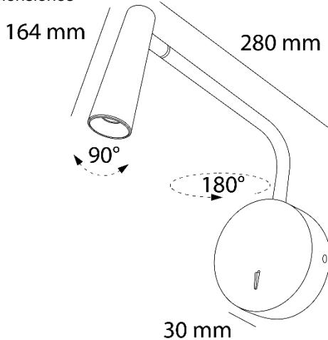
**Instalación:** Colocar la base del luminario en el muro, fijar con los tornillos incluidos en el paquete, cablear el luminario y atornillar a la base
