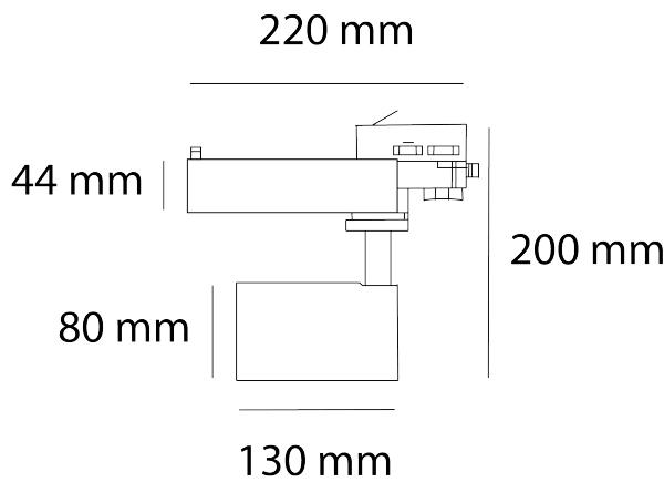
**Instalación:** Deslizar el luminario sobre el riel y poner el seguro.
