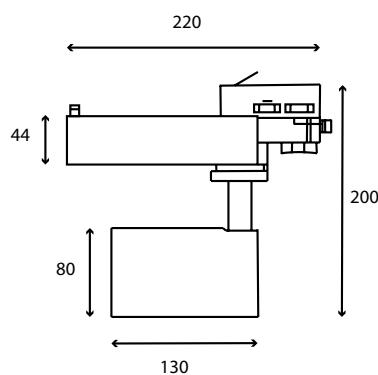
**Instalación:** Deslizar el luminario sobre el riel y poner el seguro.
