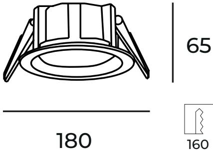
**Instalación:** Crear perforación de 160 mm y cablear el luminario. Subir los resortes y depositarlo dentro.
