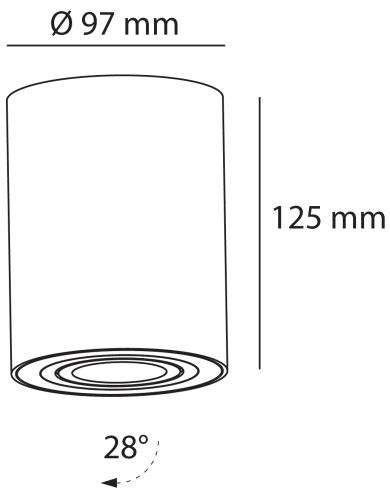
**Instalación:** Retirar la tapa superior del luminario, atornillar al techo con los tornillos y taquetes incluidos en el paquete, colocar la lámpara GU10 en la base y volver a colocar el luminario en su tapa
