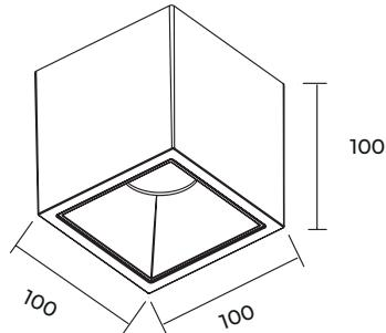
**Instalación:** Fijar la base a techo, cablear y colocar el luminario a presión en la base.
