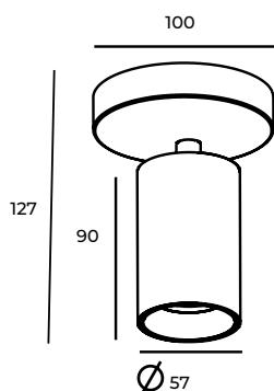
**Instalación:** Fijar la base de luminario a techo, cablear, enroscar el luminario a la base.
