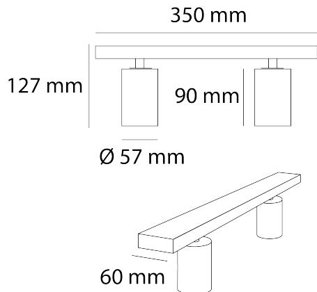
**Instalación:** Fijar la base de luminario, cablear y colocar el luminario en la base.
