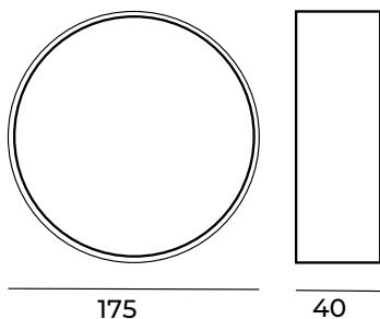
**Instalación:** Fijar la base al techo, cablear y enroscar el luminario a la base.
