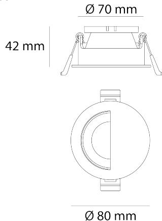
**Instalación:** Crear perforación circular de 70 mm y cablear el luminario, subir los resortes e introducir el luminario.
