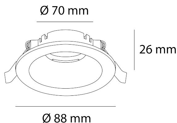
**Instalación:** Crear perforación circular de 60 mm y cablear el luminario, subir los resortes e introducir el luminario.
