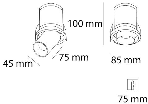
Crear perforación de 75 mm y cablear el luminario. Subir los resortes y depositarlo dentro.
