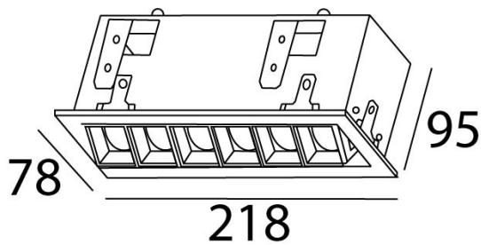
**Instalación:** Realizar un agujero cuadrado de 210 X 70 mm, cablear, colocar el luminario y girar los 4 tornillos internos para bajar los seguros.
