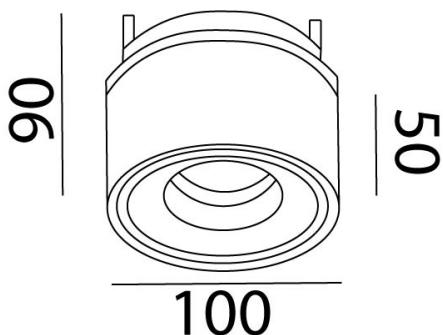
**Instalación:** Crear perforación de 93 mm y cablear el luminario, subir los resortes e introducir el luminario.
