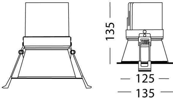
**Instalación:** Crear perforación de 125 mm y cablear el luminario. Subir los resortes y depositarlo dentro.
