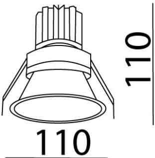
**Instalación:** Crear perforación de 100 mm y cablear el luminario. Subir los resortes y depositarlo dentro.
