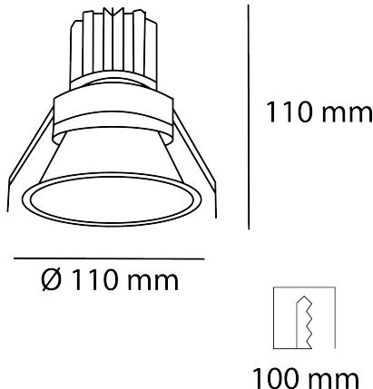
**Instalación:** Crear perforación de 100 mm y cablear el luminario. Subir los resortes y depositarlo dentro.
