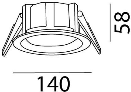
**Instalación:** Crear perforación de 125 mm y cablear el luminario. Subir los resortes y depositarlo dentro.
