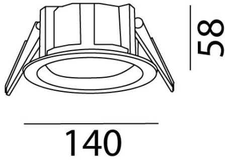
**Instalación:** Crear perforación de 125 mm y cablear el luminario. Subir los resortes y depositarlo dentro.
