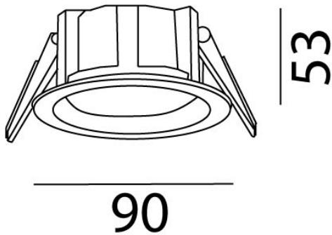
**Instalación:** Crear perforación de 80 mm y cablear el luminario. Subir los resortes y depositarlo dentro.
