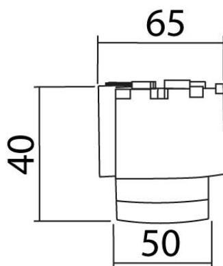
**Instalación:** Crear perforación dependiendo del arillo que se le coloque y cablear el luminario, subir los resortes e introducir el luminario.
