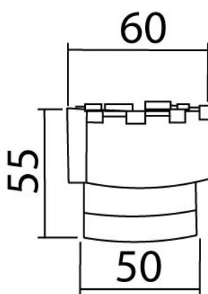
**Instalación:** Crear perforación dependiendo del arillo que se le coloque y cablear el luminario, subir los resortes e introducir el luminario.
