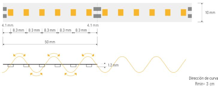
**Instalación:** Fijar al perfil despegando el recubrimiento del pegamento detrás de la tira, cablear con su driver correspondiente.
