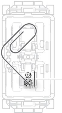
Presionar sin soltar el botón de reset hasta que el LED parpadee en verde, luego se apaga y se pone en color rojo.
