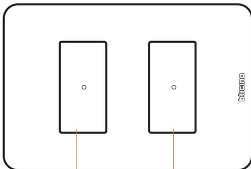
Quando se instale más de un dimmer JW4411CQ / JB4411CQ en la misma placa debe dejarse un módulo de separación.
