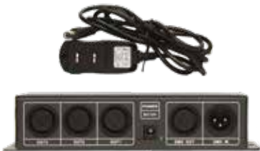
AMPL-DMX-RGB Amplificador con protocolo DMX512 para luminarias RGB
