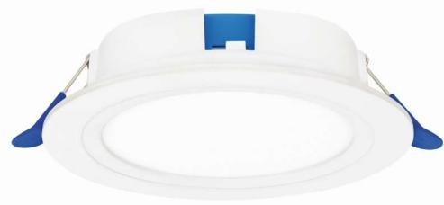
Luminario tipo downlight ultradelgado para empotrar en plafón con lámpara LED y driver insertable incluido; cuerpo circular fabricado en plástico con acabado color blanco con interruptor de tres pasos para selección de temperatura de color integrado.
