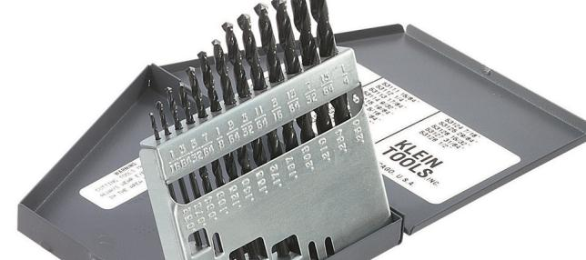
El juego contiene medidas 1/16" a 1/4" en incrementos de 1/64". La superficie ligeramente rugosa tiene mayor lubricidad para facilitar el flujo de viruta. Las brocas son de acero de alta velocidad.
