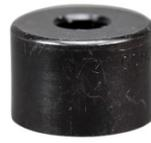
La matriz sacabocados de 7/8" perfora agujeros con facilidad en tubos conduit EMT de 1/2". El diseño optimizado reduce el esfuerzo de torsión. Los trozos de metal se dividen en el interior para su fácil extracción. También corta aluminio, fibra de vidrio y plástico.
