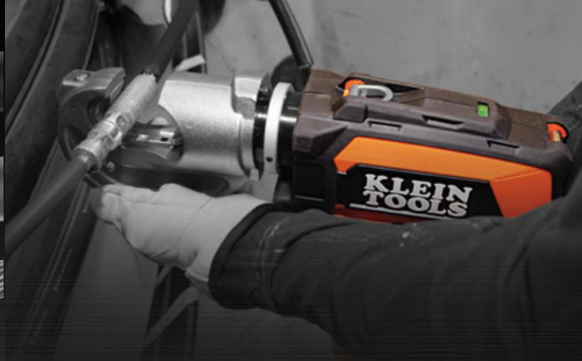
Diseñada para aplicaciones profesionales de ponchado de cables, esta herramienta ofrece 12 toneladas de fuerza para realizar el trabajo con mayor rapidez. Poncha cables de cobre, aluminio y de ACSR. La cabeza gira 360° para la flexibilidad de posición. Compatible con las normas del sector para matrices en U. Disponible con batería, estuche y cargador o solo la ponchadora.
